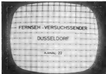
Testbild mit Stationsangabe des Fernsehversuchssenders Düsseldorf, aufgenommen mit einer Einbauantenne in etwa 8 km Entfernung vom Sender
